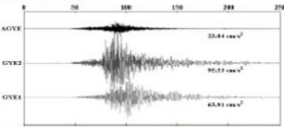
**Figura 3:** Acelerogramas del terremoto de las 18h58 (TL) del 16 de abril del 2016 ordenados con respecto a la distancia epicentral. Se han considerado las componentes con la máxima aceleración (PGA), la cual está indicada a la derecha del sismograma. El tiempo de origen (0 s) corresponde al momento de ocurrencia del evento. Se utiliza en todos los casos la misma escala vertical.
